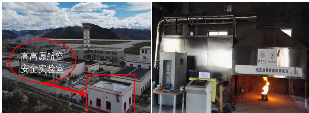
高高原航空安全实验室及全尺寸低压热释放速率测试平台
